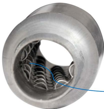
Является прямоточным, целью которого служит поглощение высокой температурной нагрузки при уменьшенном сопротивлении. Внутренняя конструкция пламегасителя придаёт выхлопным газом вращательное движение, что ускоряет их проходимость в выхлопной системе. Выхлопные газы образуют тягу, благодаря чему сами выталкиваются наружу.
