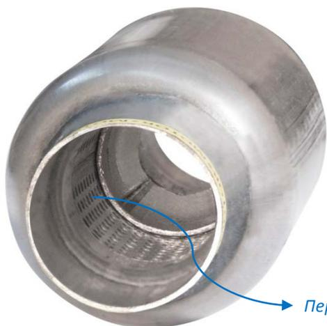
Стронгеры с перфорированным внутренним изломом, является прямоточными, целью которого служит поглощение высокой температурной нагрузки при частичном снижении шума автомобиля.
